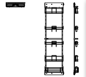
Colonna portascopie estraibile con guide telescopiche ad estrazione totale. Aggancio laterale - reversibile Extractable broom-holder column with telescopic slides, total extraction, lateral assembly - reversible
